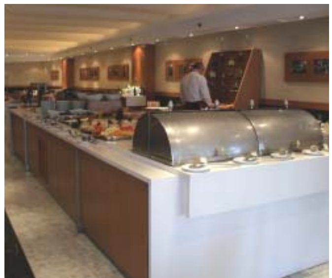
Barra Buffet que no dispone de espacio de colocación para la bandeja. Algunos alimentos no podrían ser alcanzados por una persona en silla de ruedas
